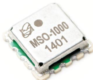
Генератор на ПАВ MSO-1000 имеет умеренно высокую фазовую стабильность и рабочую частоту 1 000 МГц. Данный тип генераторов отлично подходит для использования в качестве промежуточного сигнала в системах формирования стабильных частот СВЧ с помощью кварцевых генераторов. Основными достоинствами генератора являются малые габариты и масса, а также низкая цена.
